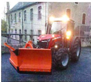
Le nouveau tracteur communal a été équipé d'une remorque et d'une étrave qui permettra d'effectuer le déneigement du village et des cités. L'équipe technique a aussi fabriqué un contre-poids pour optimiser l'utilisation de l'engin.
